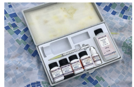
Figura 6: Il contenuto di ossigeno in acqua, misurato con un set di analisi chimiche, è di estrema importanza per i macroinvertebrati. Dipende direttamente dalla temperatura dell'acqua. © Daria Lehmann / GLOBE Svizzera
