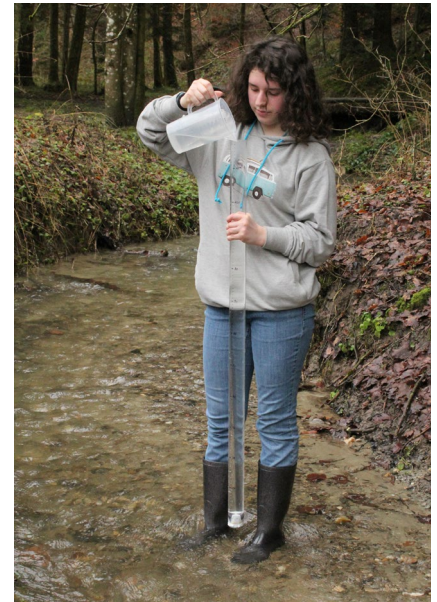
Figura 1: per misurare la trasparenza, un'allieva versa acqua in un tubo di misurazione. © Daria Lehmann / GLOBE Svizzera
